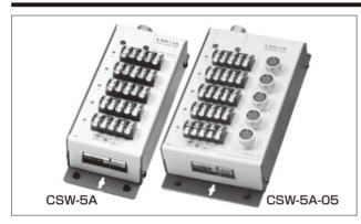
ハンドヘルドデータロガーTC-32Kと組み合わせて測定点数を拡張するためのスイッチボックスです。測定点数は5点で、ひずみ、直流電圧、熱電対、白金測温抵抗体のいずれも測定できます。
