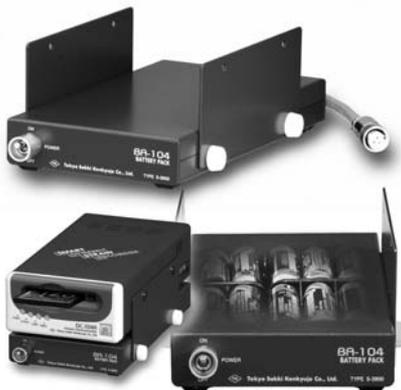
レコーダを市販の単3形乾電池（10本）で駆動させるバッテリーパックです。移動体の動的計測を可能にします。アルカリ乾電池の他、Ni-MH（ニッケル水素）電池にも対応します。バッテリーの交換時期はレコーダのLED（PWR）点滅により確認できます。また、バッテリー交換はパックを取り外すことなく底蓋の開閉だけで迅速におこなえます。
