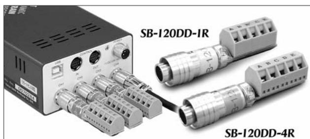
超小型動ひずみレコーダDC-104R/DC-104Ra専用のブリッジボックスです。「SB-120DD-1R」は1ゲージ3線法で120Ωのひずみゲージを、2ゲージ法で120Ω、350Ωのひずみゲージを測定することができます。「SB-350DD-1R」は1ゲージ3線法で350Ωのひずみゲージを、2ゲージ法で120Ω、350Ωのひずみゲージを測定することができます。「SB-120DD-4R」は4ゲージ法で測定する場合に用います。接続できるひずみゲージは120、350Ωです。
