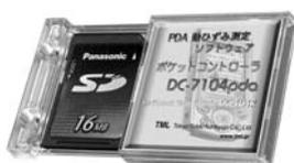
携帯情報端末用にデザインされたソフトウェア、ポケットコントローラDC-7104pdaです。測定時には携帯情報端末に装着しておき、測定データはレコーダに装着されたCFメモ리카ードに自動的に記録します。
