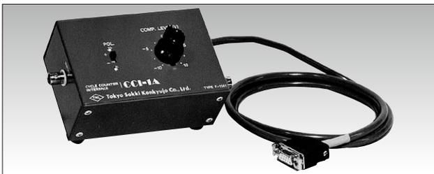
DRAモデルへのサイクルカウント入力用に開発されたインターフェースです。疲労試験機における繰り返し数を電圧レベル入力でカウントします。入力電圧のアナログ信号をTTLレベル（0/5V）に変換しDRAモデルへ出力します。回数を測定するだけでなく本器からデジタルレコーダなどの外部記録器へもTTLレベルで出力できます。
