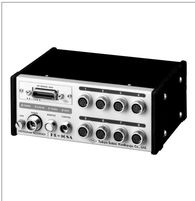
ひずみゲージ、ひずみゲージ式変換器などからのアナログデータをデジタル処理し、頻度解析を行うシステムです。ヒストグラムレコーダHR-908Aは豊富な解析プログラムと大容量メモリを備え、ふたつ以上のプログラムによる同時解析や、ファイル機能による複数回の頻度データ記録が可能です。実時刻タイマによるプログラム自動測定、最大±50スライスの分解能、波形記録など、多くの機能を備えています。電源はDC10.5~30Vで、長期にわたって安定した測定が行えます。初期設定や記録データの読み出しは、ヒストグラムレコーダ本体に装着のGP-IBまたはRS-232Cインターフェースによりパソコンを接続して行います。記録データを直接パソコンに転送できるため、汎用性のある計測システムを展開できます。
