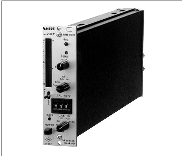
電子式自動バランス方式採用の差動トランス用増幅器です。LEDモニタ、デジタル校正値設定など操作性に優れ、小型軽量設計により多チャンネル構成も容易です。さらにローパスフィルタ、デュアル出力など使いやすさを高める機能を備え、通常の動ひずみ測定器と同様の感覚で使用できます。精度、安定性などの基本性能も一段と向上しています。
