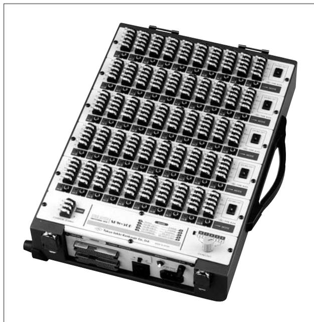
高速データロガーTHS-1100と組み合わせて高速で多点測定を行うためのスイッチボックスです。測定点数は50点で、ひずみ、直流電圧が測定できます。測定点の切換えには、従来の機械式リレーに代えて機械的可動部の無い半導体リレーを採用。同時多点モニタおよび計測頻度の高い高速、多点測定に対しても長期安定性、高信頼性を実現しています。
