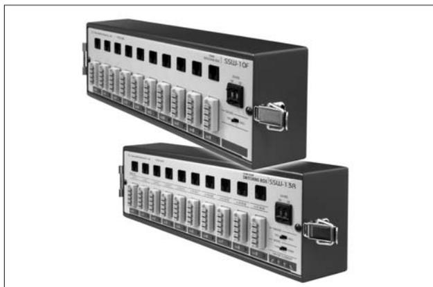
リード線の抵抗変化による測定誤差を生じない1ゲージ4線式専用のスイッチボックスです。モジュラープラグによるワンタッチ結線が可能で、確実にスピーディな作業効率化を図れます。データロガーTDS-530、TDS-602またはTDS-303と組み合わせて使用します。従来のスイッチボックスASW、SSWと接続し同時に測定することもできます。SSW-10Fは1ゲージ4線式の単軸ゲージを用いて1台10点の測定が可能です。SSW-13Rは1ゲージ4線式の3軸（ロゼット）省配線ゲージ（3ゲージ6線式）と併せて使用できます。従来の3軸ゲージでは9本のリード線が必要でしたが3ゲージ6線式では6本に削減した省配線型になります。1台で3軸×10点（合計30点）の測定ができます。
