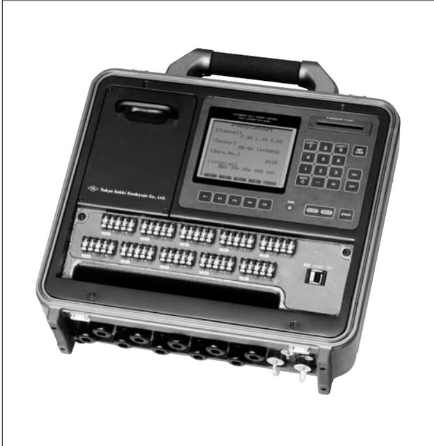
商用電源のない場所での長期間自動計測を目的としたデータロガーです。シール鉛蓄電池とスリープ機能付きのタイマにより、一定時間間隔ごとに各点の測定値をデータメモリに記録します。測定点数は本体のみで10点、外部に専用スイッチボックスを接続すれば最大50点まで拡張できます。各点とも、ひずみ、熱電対温度、直流電圧の測定が可能です。データメモリの測定データをメモリカードに記録することで、本体がなくてもコンピュータでデータを読み出すことが可能です。また、内蔵のRS-232Cインターフェースを用いて、コンピュータによるコントロールやデータ転送もできます。厳しい環境下での使用を考慮して強度、防水性、防塵性なども重視した設計となっています。また内蔵バッテリーは交換可能で、外部バッテリーを使用することもできます。
