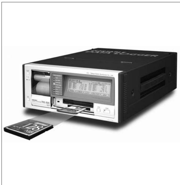
ひずみゲージをはじめ直流電圧や熱電対、白金測温抵抗体などの多量の自動切換測定を目的としたデータロガーです。測定点数は本体だけで最大30点、外部スイッチボックスを併用して最大1000点までの測定がおこなえます。A/D変換部は当社で長く実績のある三重積分方式（特許）を採用し、高精度、高安定を実現しています。ひずみ測定では、従来の方法より高精度な、初期ひずみに影響されない、ブリッジ回路の非直線性誤差がゼロの完全な補正方法を搭載しています。アップグレードしたTDS-303<sup>FLASH</sup>は、フラッシュメモリカードスロット、Ethernet LANが標準装備されました。またオプションでは新しい計測システムとして【1ゲージ4線式計測システム】と【デジタル変位計測システム】をラインアップし、従来モデルと併せて機能をよりスマートに拡張しています。
