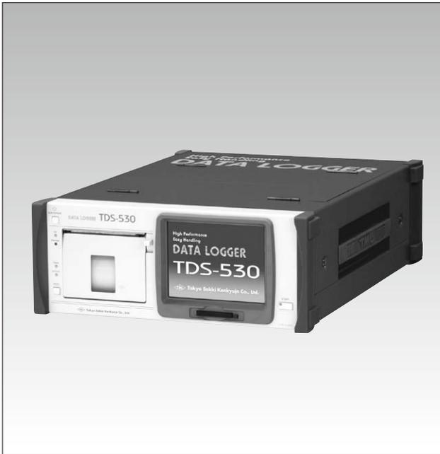
本器はひずみゲージをはじめ温度、直流電圧や熱電対、白金測温抵抗体などの多点自動切換測定を目的としたデータロガーです。測定点数は本体だけで最大30点、外部スイッチボックスを併用して最大1000点までの測定が行えます。A/D変換部には新たに開発した倍速積分演算方式を採用し、高速、高精度、高安定を実現しています。また、高速スイッチボックスIHW-50Gとの組合せで従来の高速データロガーを大幅に凌ぐ1000点0.4秒の測定を実現しています。カラー液晶表示とタッチパネルでわかりやすい操作性を提供します。インターフェースはEthernet LAN、USBおよびRS-232Cの3種類を搭載し、ご利用の環境・用途に合わせたシステムを構築できます。
