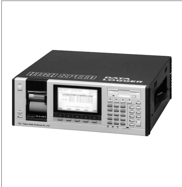
ひずみゲージ、ひずみゲージ式変換器および直流電圧、熱電対温度などの多点測定のためのデータロガーです。特に高速測定を目的としており、専用スイッチボックスを併用して最大1000点を1秒でサンプリングすることができます。測定値の一時記録のために大容量のデータメモリを備えているため、データ転送に要する時間を省き、短い間隔で繰り返し測定を行うことも可能です。したがって、測定値に同時性を要求される測定や、多点の測定などに特に効果を発揮します。GP-IBおよびRS-232Cインターフェースを備えており、パーソナルコンピュータを接続してコントロールやデータ転送が行えるため、高度な計測システムを構築できます。また内蔵フロッピーディスクによるデータ記録や、液晶ディスプレイによるグラフィック表示も可能です。
