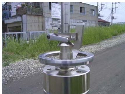
落下高さ 30cm から 6 回測定 (規定の変位量が概ね得られる落下高さの-10cm)
