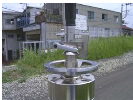
落下高さ 50cm から 6 回測定 (規定の変位量が概ね得られる落下高さの+10cm)
