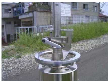
落下高さ 40cm から 6 回測定 (規定の変位量が概ね得られる落下高さ)
