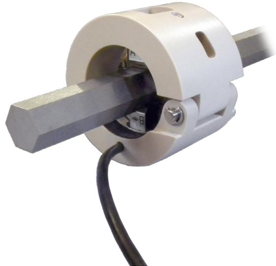
摩擦型軸ひずみ計はタイロッド（テンションロッド）の軸ひずみを測定するセンサです。従来のひずみゲージや荷重計によるタイロッド軸力測定では、タイロッドの取り外しや加工が不可欠でしたが、この軸ひずみ計は摩擦型ひずみゲージを用いているため不要で、既設部材を挟み込みねじ止めするだけで装着が完了し、測定ができます。スペーサ・固定金具の交換により丸棒、六角断面のロッド軸ひずみ測定に使用できます。
