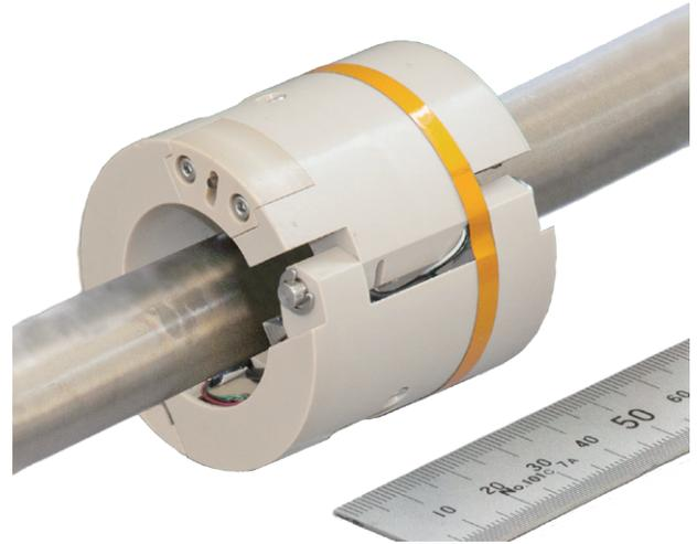
摩擦型トルクセンサシステム FGDH-2A は摩擦型ひずみゲージの採用により、接着型のひずみゲージでの接着する準備やリード線の面倒な配線作業を必要としません。取付けは自動車のドライブシャフトを挟み込み、ねじで締結するだけで、ドライブシャフトのトルクを無線によるテレメータ測定ができます。デジタルテレメータ受信機 DT-041R-1 によりアナログ電圧出力されますので、様々なレコーダに記録できます。【特許登録済み】
