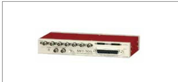
超小型車軸6分力測定器 MFT-306 は車軸に取付けた車軸6分力荷重計により、タイヤが路面より受ける外力を直交3分力およびその周りの3モーメントで入力します。入力信号はデジタル変換したのち、各分力間の相互干渉補正、エンコーダの回転信号による回転補正をデジタル演算します。6分力信号、タイヤ回転数を前面パネル出力コネクタより電圧出力します。設定、モニタ表示はパソコンでおこない最大4台の車軸6分力測定器のコントロールをおこないます。設定後、パソコンを外し、単体で測定ができます。
