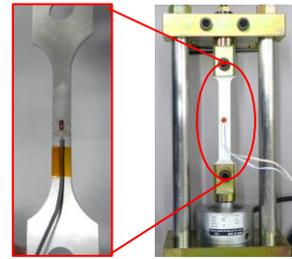
本システムは金属材料の機械的性質を調べるために、**材料試験(弾性域・塑性域)のひずみ測定**で広く使用されています。100ms/SCNの高速サンプリングで、**平均値(裏表2枚)・Max/Min値を数値モニタ及びグラフ描画もリアルタイム表示**。試験機からの**電圧信号も取込み可能**。
