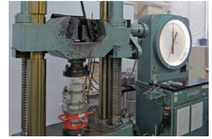
コンクリート圧縮強度・静弾性係数を測るための測定システムで、普通コンクリート・高強度コンクリートなど、様々なコンクリートテストピースの測定に使用されています。表裏2枚のひずみゲージの測定値および平均値をリアルタイム表示、試験機からの電圧信号も取り込み可能です (Max/Min値を表示可能)。
