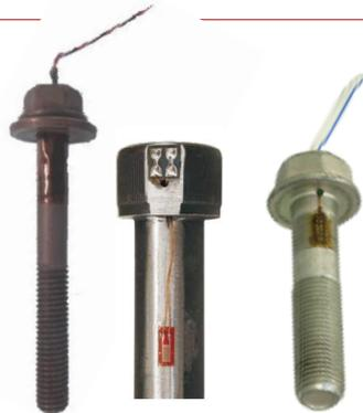
「ボルトの軸力測定」
