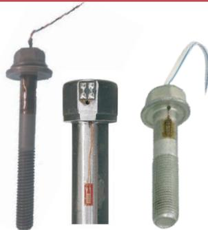
「ボルトの軸力測定」
