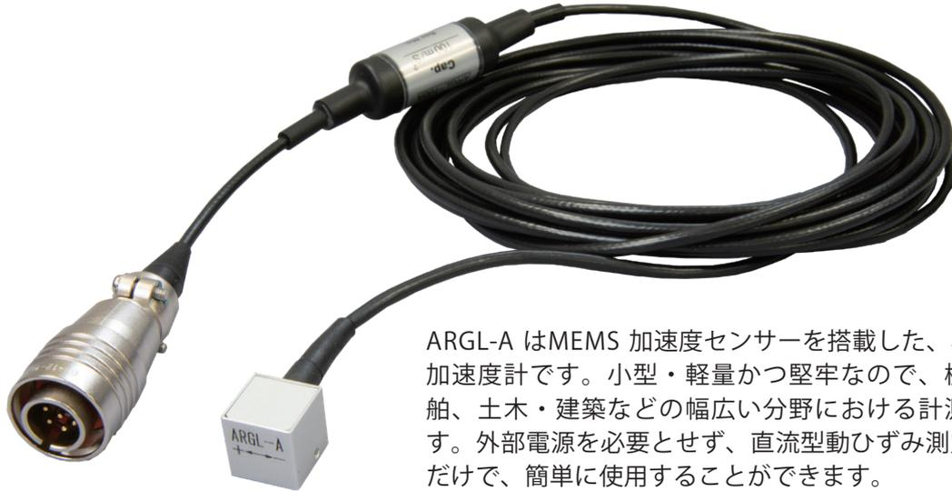
ARGL-A はMEMS 加速度センサーを搭載した、小型・高応答の加速度計です。小型・軽量かつ堅牢なので、機械、車両、船舶、土木・建築などの幅広い分野における計測に使用できます。外部電源を必要とせず、直流型動ひずみ測定器に接続するだけで、簡単に使用することができます。
