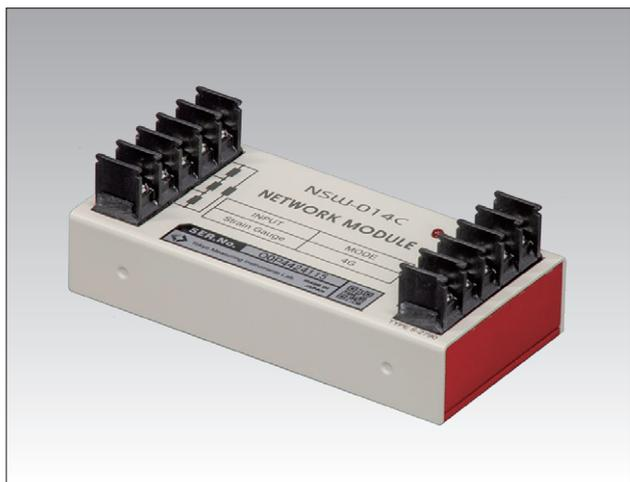
ネットワーク型計測システムTML-NETを誘導雷から保護するものです。雷の発生しやすい地域で、測定器やネットワークモジュールなどのケーブルに誘導雷を受けると、誘導電流によりネットワークラインに接続したネットワークドライバ、ネットワークモジュールが故障する原因となります。延長するネットワークラインの両端に本器を接続し、測定待機中になると、ネットワークラインを自動的に切り離し、ネットワークラインが誘導雷を受けたとき誘導電流を阻止し、ネットワークドライバ、ネットワークモジュールを保護します。
