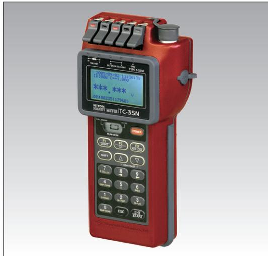
ネットワーク用ハンドヘルド測定器TC-35Nはネットワークモジュールからのデジタル化したひずみデータの取り込み、処理をおこないます。小型、軽量、防滴構造となっており、単3形アルカリ乾電池で動作しますので現場でのチェックや小規模な計測システムとしての測定ができます。また、スリープインターバルによる長期自動計測ができます。測定したデータはRS-232Cインターフェースを介してパソコンにデータを転送したり、データメモリ、CFカードに記録できます。
