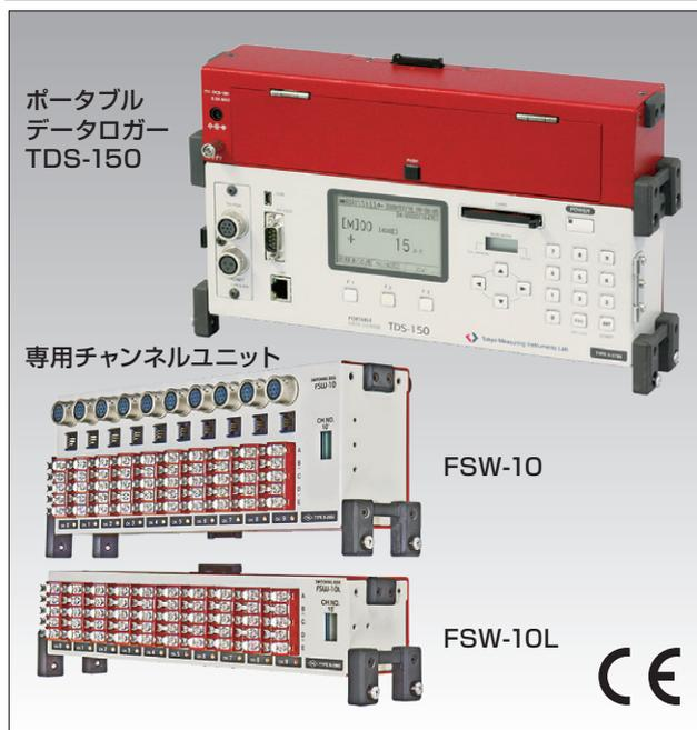
本器は専用チャンネルユニット (FSW-10/FSW-10L)を組み合わせてひずみゲージ、ひずみゲージ式変換器、直流電圧、熱電対、白金測温抵抗体の測定ができるポータブルデータロガーです。10チャンネルユニット (FSW-10/FSW-10L) は最大5台 (50チャンネル) まで接続できます。またスイッチボックスTML-NET駆動ボード (オプション) によって最大100チャンネルまで接続できます。AC電源のとれない場所でも、市販の単1形アルカリ乾電池やバッテリーで動作でき長期にわたり自動測定が可能なデータメモリ、スリープインターバルタイム機能を搭載していま
