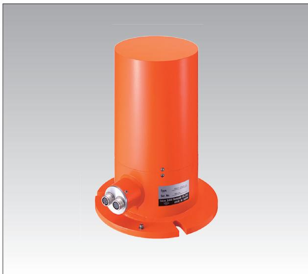
地表面に取り付けて地盤内の各層の沈下量を測定する沈下計です。ボーリングした孔内の目的の位置に専用アンカを取り付け、アンカと地表面間の変位を測定します。1 ボーリング孔内の測定段数は、最大 6 段です。
