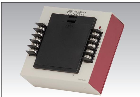
雨量、流量、数量、車両通過台数、機械の稼働回数等は無電圧接点またはオープンコレクタ入力でカウントするモジュールです。内蔵バックアップ電池により、電源が給電されていない場合でもカウントを継続できます。
