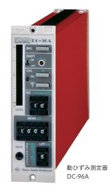
小型で使いやすさを追求した広帯域直流型の動ひずみ測定器です。 感度調整にはデジタル感度設定方式を採用し、正確な感度調整が行 えます。電子式オートバランスの範囲および確度を従来に比べ向上 させ、広範の計測に使用できます。また、容量バランスは直流型の ため不要です。さらにブリッジ電源は定電圧方式、定電流方式のど ちらも選ぶことができます。ブリッジ電源に定電流方式を用いると ひずみゲージ式変換器やブリッジボックスとの間の接続ケーブル抵 抗による感度低下がありません。単体で1チャンネル用ですが専用 ケース、ラックに組み込んで多チャンネルに構成できます。
