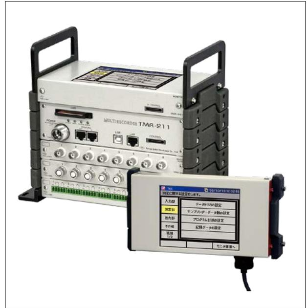
マルチレコーダTMR-200シリーズは、目的に応じた各種センサ入力ユニットが容易に組合せ可能な小型多チャンネルデータ収録システムです。100kHzの高速サンプリングが可能で、センサ入力ユニットには、ひずみ、電圧、温度などのアナログ入出力だけでなく、CANなどのデジタル入出力も用意され、1台で最大80点の測定が可能です。波形記録だけでなく、リアルタイムで頻度解析処理(オプ
