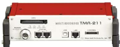
10台までの各種測定ユニットを制御しデータを収録するコントロールユニットです。
