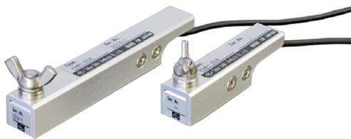
磁石の吸着力を利用し鋼材の塗膜の上から簡単に素早く取付けてひずみを測定できるセンサです。接着タイプのひずみゲージのような下処理や接着作業が不要で作業を大幅に短縮でき、小型・軽量でかつ、堅牢であるため可搬性にも優れています。また、一般的なひずみゲージとは異なり再利用出来ます。さらに、鋼材だけでなくコンクリートや樹脂などには、治具や接着剤などで取付けて測定することが可能です。
