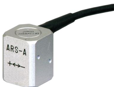
橋梁のケーブル張力をはじめとした構造物や機械の振動モードの測定に適した小型の加速度計です。10m/s<sup>2</sup>で30000×10<sup>-6</sup>ひずみと高感度なので、微小な振動を測定することができます。
