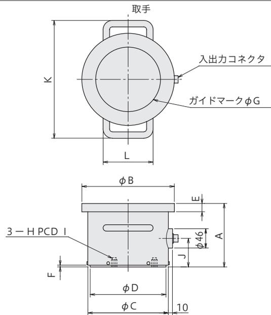
一般用コンクリート円柱供試体の強度試験に使用する荷重計です。荷重計上部の面に円柱供試体をそのままのせることができます。また、コンプレッソメータを併用することにより、荷重とひずみが同時に測定できます。
