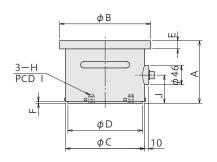
載荷面がフラットな荷重計です。用途としては、コンクリート円柱 供試体の強度試験に使用します。容量によって載荷面にコンクリー ト円柱供試体に合ったガイドマークが付いているため位置出しが容 易にできます。
