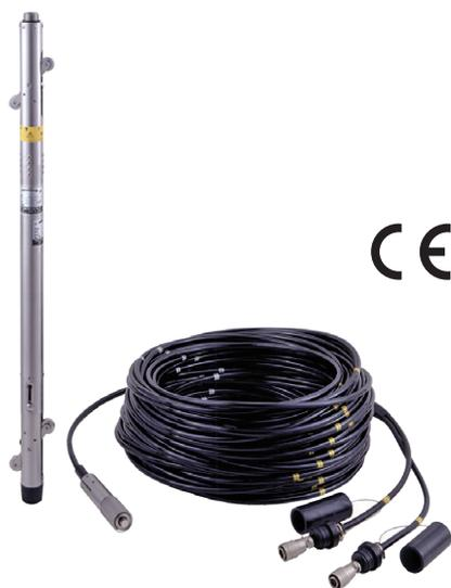
地盤や構造物の変位を測定する傾斜計です。あらかじめ、専用ガイド管を地盤や構造物に鉛直に設置し、傾斜計を挿入して管内の傾斜角を測定し、変位量を求めます。地山の地滑りの変位測定や土留め壁の変位測定などに使用されます。また、KB-HC型は、X方向とY方向が同時に測定できます。
