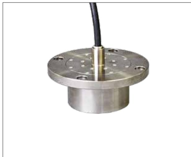
ケーソン刃口部に作用する地盤反力(支持力)を測定する変換器です。ケーソンの刃口部底面に本体受圧面が面位置になるように設置することで沈設時、定着時の地盤反力を測定します。
