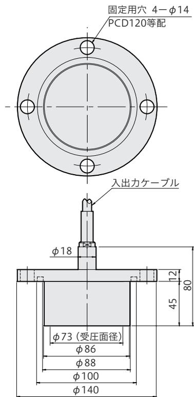
ケーソン刃口部に作用する地盤反力(支持力)を測定する変換器です。ケーソンの刃口部底面に本体受圧面が面位置になるように設置することで沈設時、定着時の地盤反力を測定します。
