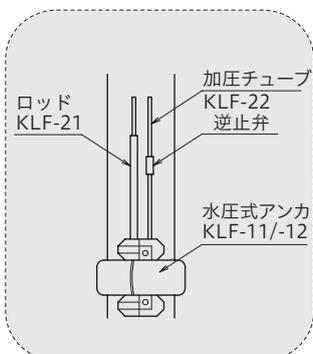
出力極性は本体と水圧式アンカーとの距離が縮む方向に対してプラス⊕出力を指示します。
