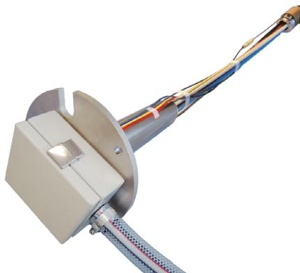
岩盤変位計KLB-Bは取付面と岩盤内の測定点との間の変位量を測定する変位計です。変位センサ部となる岩盤変位計KLB-Bと岩盤内に定着させる水圧式アンカ (KLF-11/12) および、それぞれをつなぐロッド (KLF-21) で構成されます。岩盤変位計には、最大8台の変位計を内蔵していますので、1本のボーリング孔 (測定点数1~6点の場合はφ66mm以上、7、8点の場合はφ86mm以上) に8点の水圧式アンカを定着させて測定できます。変位計とアンカの間に生じた変位量はロッドを介して相対変位量として検出されます。アンカはボーリング孔内の所定の測定点において地上よりポンプで水圧をかけて岩盤に定着させます。
