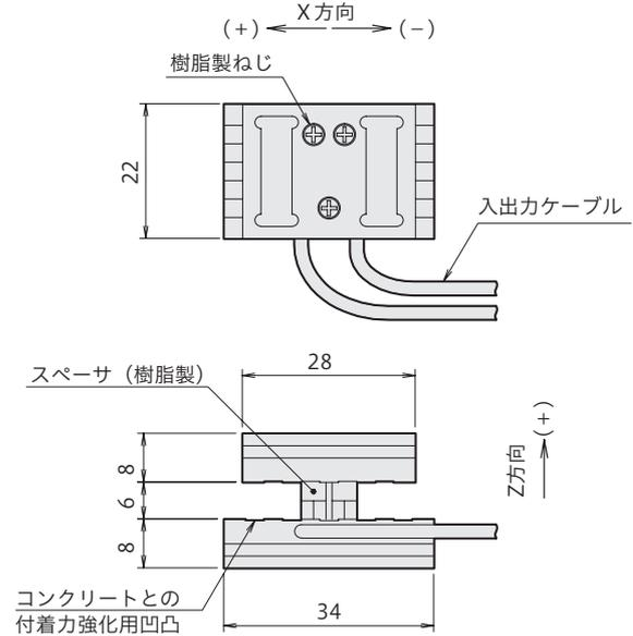
コンクリート構造物の前打コンクリートと後打コンクリートの打継目の挙動を捉えて、ずれ変位量を測定するセンサです。2点間を非接触で測定することで、打継目の挙動に影響を与えずに測定できます。また、小型・軽量で取扱いが容易で、せん断方向(X方向)の変位だけでなく、クラックなどの発生により境界面が剥離する方向(Z方向)の測定も可能です。さらに、埋設だけでなく、コンクリート表面、鋼材表面(但し、磁化されていない)にも適応可能です。
