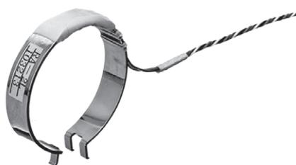
金属材料の低温雰囲気におけるCOD（亀裂開口変位）測定を目的とした変位計です。
