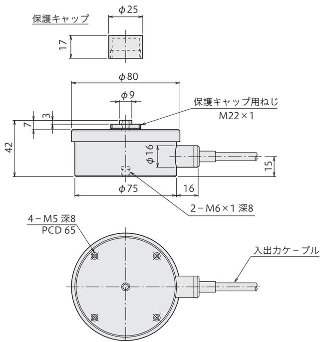
低容量の引張圧縮両用型荷重計です。両端固定梁を起歪部に使用した内部構造により高精度な測定が可能です。
